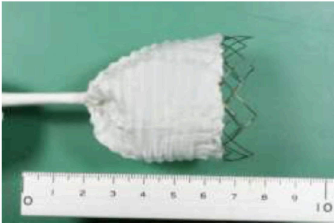
図 5. 内径 12F の細いシースから押し出されたステントグラフト
